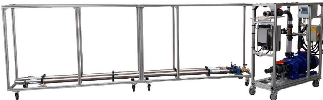
Abbildung 1. Membraneinheit (links) und Pumpeneinheit (rechts)
