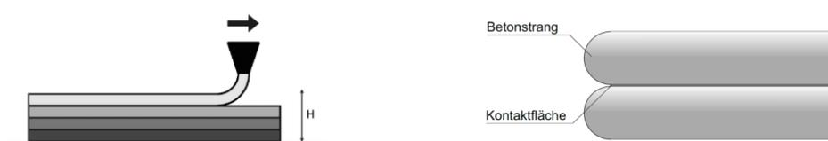
Abb. 2. Schichtweiser Materialauftrag mit unterschiedlichem Betonalter bzw. Hydratationsfortschritt (li.); Veranschaulichung der potenziellen Schwachstelle „Kontaktfläche“ durch Querschnittsverminderung (re.)
