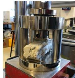
Abb. 1. Gedruckte Prüfprismen für Biege- und Druckfestigkeitsversuche (li.); gedrucktes Prisma (160x40x40mm) im Biegezugversuch (re.)
