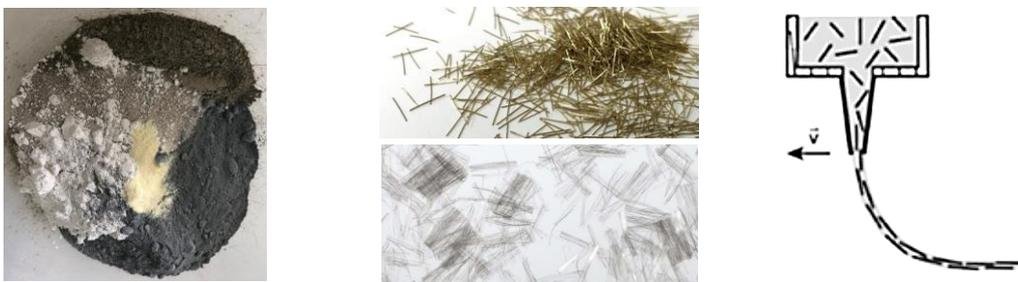
Abb. 4. Trockenbestandteile der entwickelten Betonmischung (li.); Stahl- und PP-Fasern (Mitte); Ungewünschte, prozessbedingte Orientierung der Fasern parallel zur aufgetragenen Betonschicht (re.)
