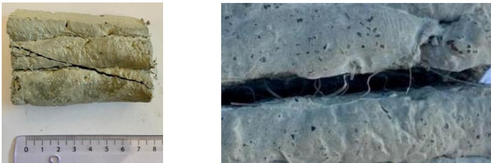
Abb. 5. Häufigster Versagensfall bei faserverstärkten Betonen: Abscheren über mehrere Schichten (li.), Fasern durchdringen und überbrücken die Kontaktflächen (re.)
